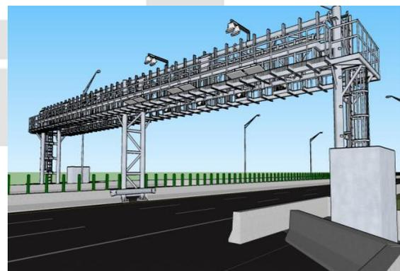
圖 1 多車道自由車流電子收費系統
