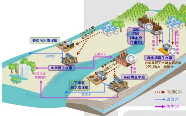
圖 1 系統與非系統再生水示意圖
