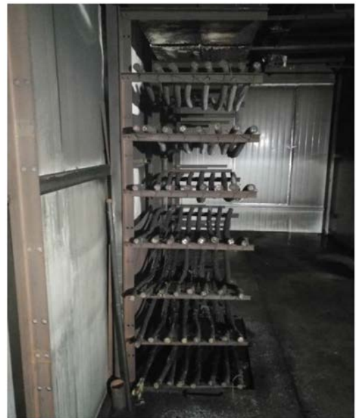
圖 6 試驗前電纜外觀圖
