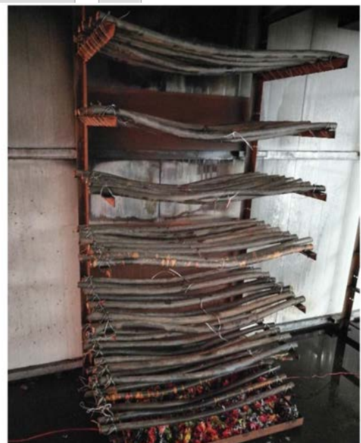
圖 7 試驗後電纜外觀圖
