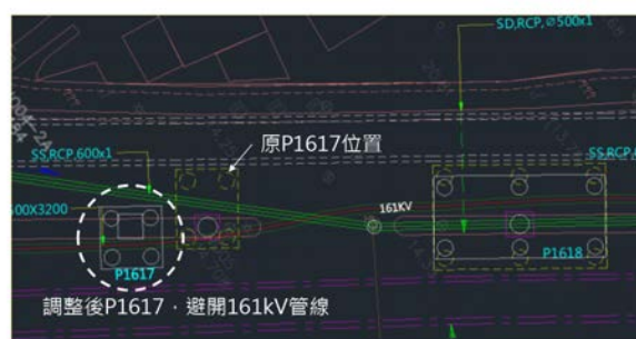
圖 3 配合現場狀況，調整橋墩及基樁位置，以確保不會與既有管線衝突
