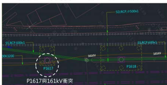
圖 2 營造廠 161Kv 特高壓慣性定位座標資料及污水管調查資料套繪橋墩
