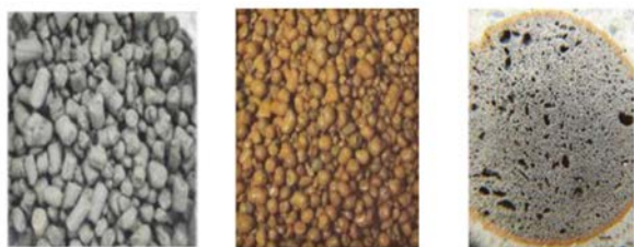
圖 1 輕質粒料（明春窯業燒製石門水庫淤泥）
