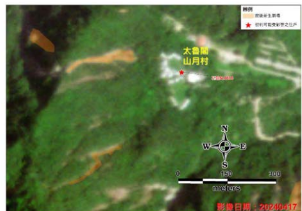
圖 6 0403 震後新生崩塌經評估具保全住戶，但未具備溪谷地形 (Type C 示意圖)
