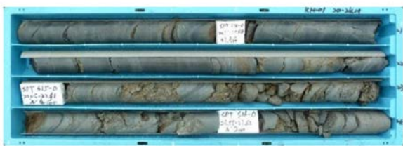
(B) PVC 管遮住部分岩心。建議改善方式：拍照前檢查並調整 PVC 管。
