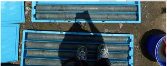
(B) PVC 管遮住部分岩心。建議改善方式：拍照前檢查並調整 PVC 管。
