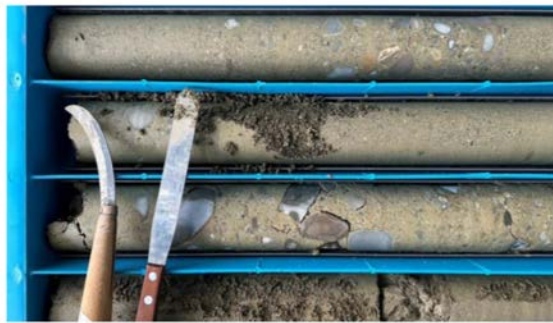
圖 1 平原區鑽探岩心表層刮開範例
