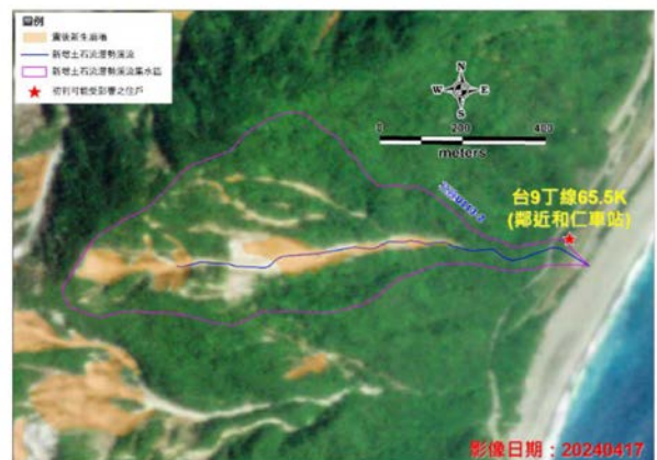
圖 5 0403 震後新生崩塌具備溪谷地形與保全住戶，但非位於土石流潛勢溪流集水區 (Type B 示意圖)
