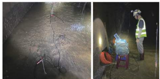
圖 6 桃園大圳導水路第三號隧道內地電阻影像探測實況（本團隊拍攝）
