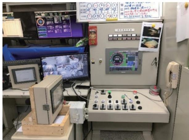
圖 11 潛盾機之遠端操作系統
