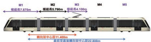
圖 2 安坑輕軌列車構成
