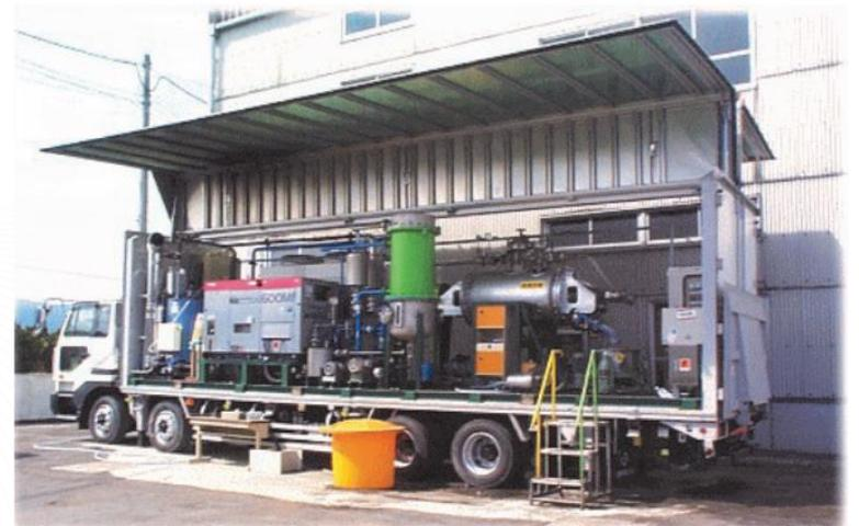
卡車型油溫減壓乾燥設備
